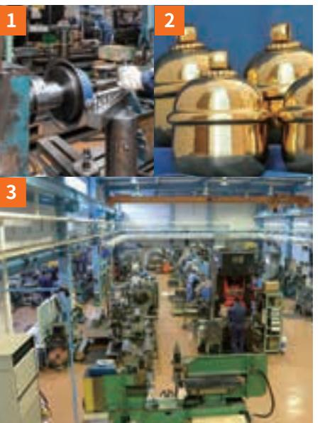
1 加工に使う機械。金属をへら棒で伸ばして成形する。
