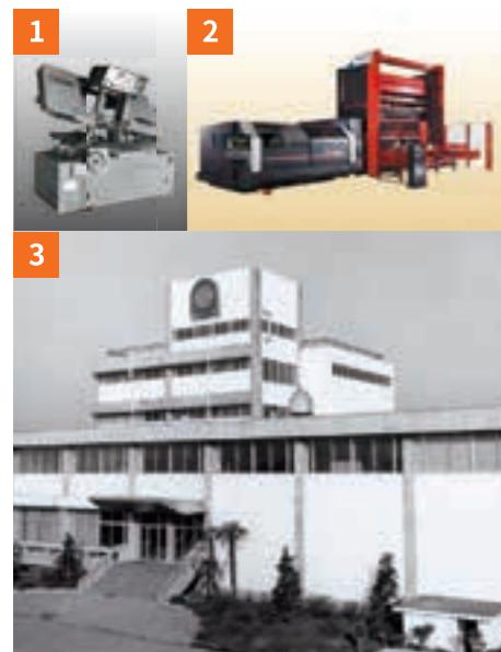
1 約50年前に開発。帯状のこぎり刃を回転させて金属を切断加工する機械。
