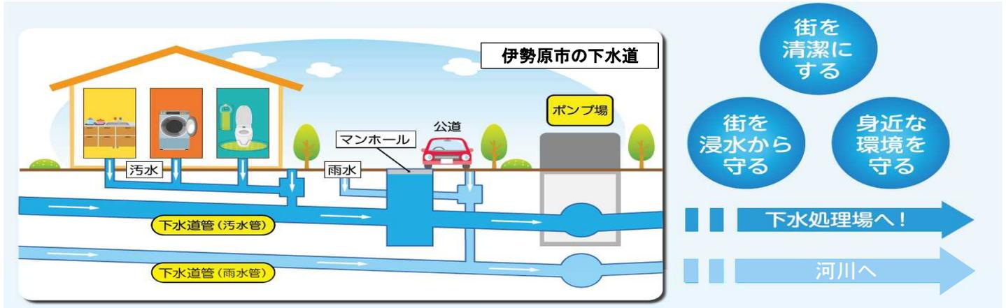
下水道は安全で快適な生活環境を維持するため、重要な役割を果たしています。例えば、トイレや台所などの汚水は汚水管を通り、処理場できれいにして河川へ放流しています。また、雨水は道路側溝から雨水管に入り河川へ流れ、浸水を防いでいます。
