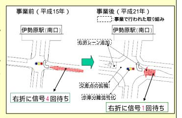
右折レーンの設置や信号改良により、事業前の交差点を通過するまでに要する信号サイクルの回数が4回であったのに対して、事業後は1回に減少しており、交差点の混雑が緩和され、交通の円滑化が図られたといえます。
