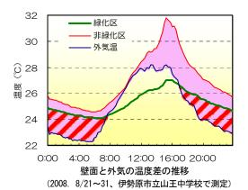
ヒートアイランドの原因の一つは、建物などの構造物からの放熱です。壁面の温度が外気温より高いときに、壁面の熱が建物から空気に移動して空気を暖め、気温が上昇します。左のグラフは、南西向きの壁をアサガオで緑化(緑被率89%)したときの壁面の温度と外気温の変化を示しています。グラフの非緑化区の壁面 ――と外気温 ――で囲まれたピンク色で示した部分が緑化をしていない壁から空気に移る熱、緑化区の
