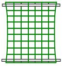
左の図のように、ネットの上端と下端に支柱を取り付けます。棒を網目に交互に通し、結束バンドで固定します。ローブなどを使って、上の支柱をバルコニーの手すりなどに、下の支柱をプランターに固定します。このとき、ネットがピンと張るようにしっかり結びつけます。下の支柱にレンガなどの重しをつけたり、風であおられないようにネットの両わきを壁などに固定できれば、より安心
