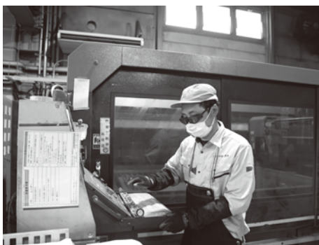
レーザーを使い鉄板を切断します
