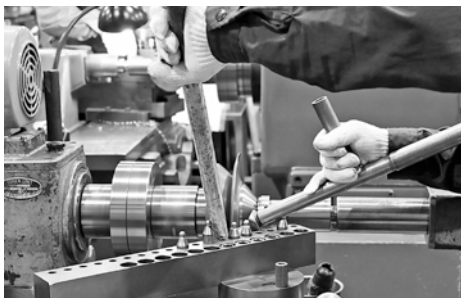
へら棒を使って慎重に金属を成型
