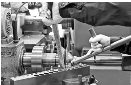
へら棒を使って慎重に金属を成型
