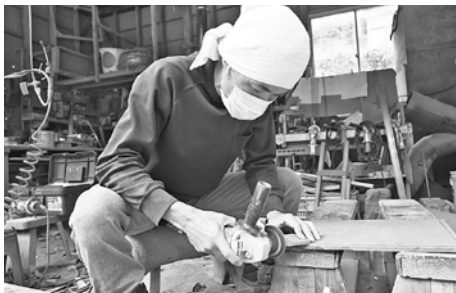
断面を整えるための研磨
